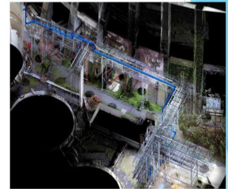
D.配管点群取得及び新規配管モデル作成（新規モデル青色・緑色部分）
